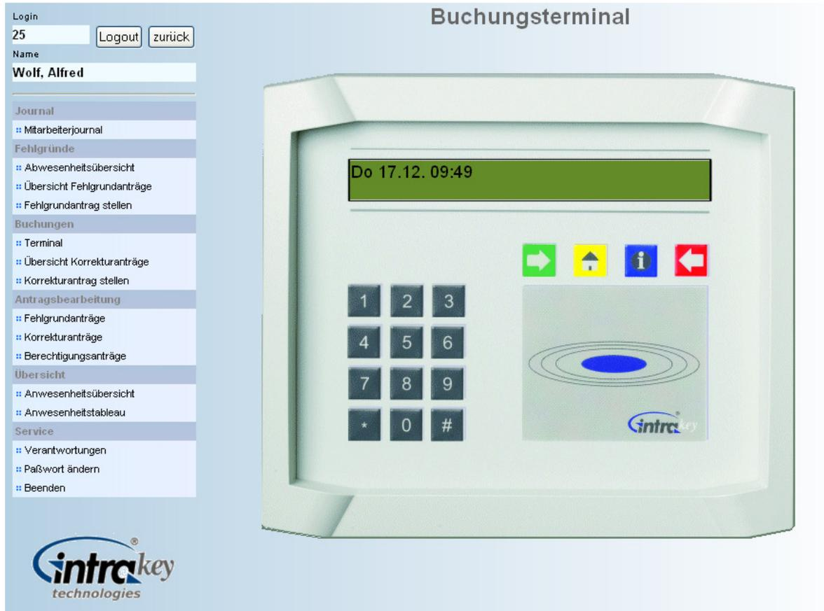
Die Bedienung gestaltet sich fast identisch zum Hardware-Terminal. Die Abfolge der Handlungen nehmen Sie mit der Maus vor. Die Funktionstasten des Nummernblocks sind nur belegt, wenn Sie zuvor im System C/3 frei geschaltet wurden.
